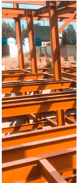
Очистка, термообработка и грунтовка производится на немецком оборудовании. В изготовлении листовых металлоконструкций, закладных деталей используется плазменная и газовая резка. Все работы выполняются в заводских условиях при высоком уровне технологического процесса. Наше производство строительных металлоконструкций отвечает всем предъявляемым к нему требованиям СНиП.
